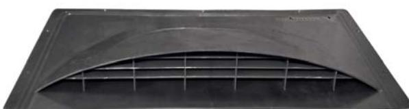
Аэратор «AQUASYSTEM» пластиковый «Стандартный» предназначен для вентиляции подкровельного пространства при уклоне скатов не менее 45 градусов.
